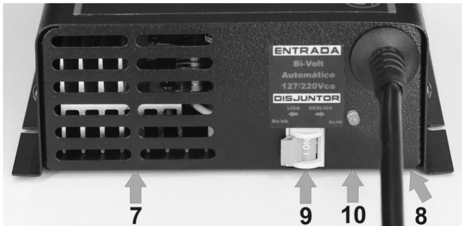
**7 – Saída de Ar.** Saída de ar para a ventilação e resfriamento da fonte, não obstruir de forma alguma, sempre deixar um espaço de no mínimo 5cm para uma perfeita ventilação do equipamento.
