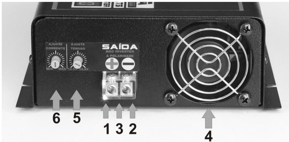
**1 – Saída Terminal Positivo.** Conectar a bateria, barramento ou ao equipamento a ser alimentado (Verificar bitola do cabo na tabela de características). Nunca inverter a polaridade.
