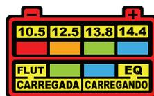
Indica através dos led's coloridos a tensão da bateria entre 10,5 e 14,4V e a situação de sua carga.
